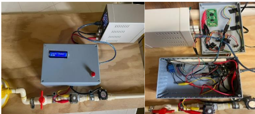
Figura 4. Caja de conexiones y su interior. Fuente: Propia.
