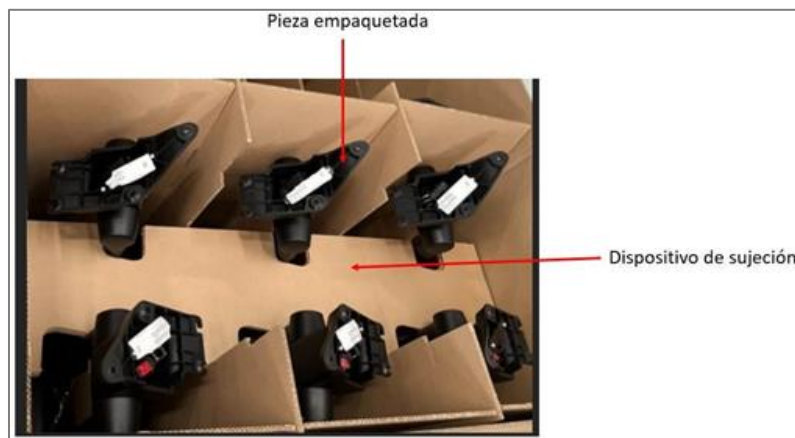
Figura 5. Dispositivo de sujeción para eliminar el movimiento causado por la inercia durante la transportación.
