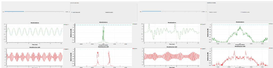
Figura 26. Graficas de la moduladora y la señal modulada en el dominio del tiempo y frecuencia de la señal de entrada senoidal (arriba) y entrada de audio (abajo).
