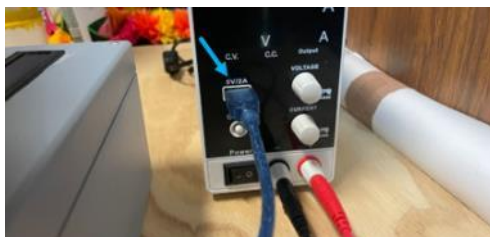
Figura 10. Fuente de alimentación 5V. Fuente: Propia.
