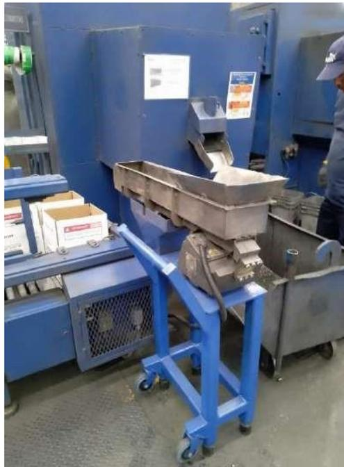
Figura 9. Soporte para tolva adaptado en uso.
